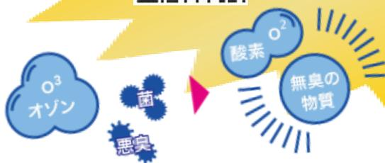
オゾンの殺菌機構 オゾンが分解すると酸素と発生期の酸素を生成しますが、このうちの酸化力の強い発生期の酸素が、細菌の細胞壁や細胞膜に作用することにより機能を変化させ、最終的に菌を溶かしてしまうものと考えられています。
